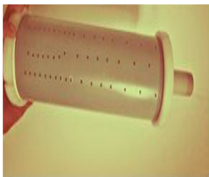
Fig. N°1: Hipoclorador por difusión
